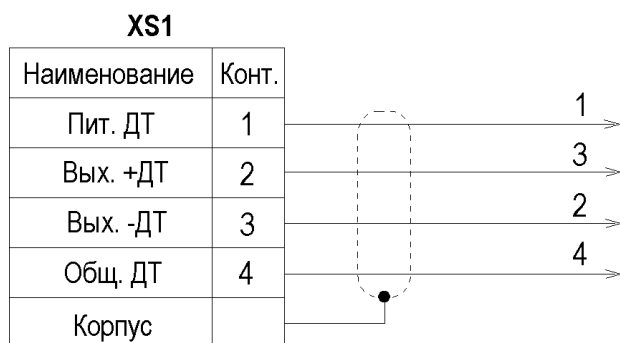
Рисунок К.11 - Кабель КРАУ4.853.820 для подключения термометра сопротивлений к прибору «ГиперФлоу-3Пм»
