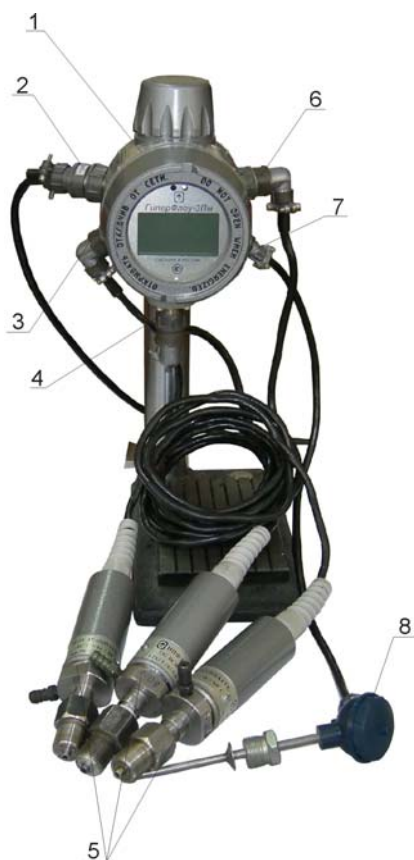
Рисунок 3 – Модель 1000 (режим многопараметрического датчика, подключение до четырех датчиков давления)
