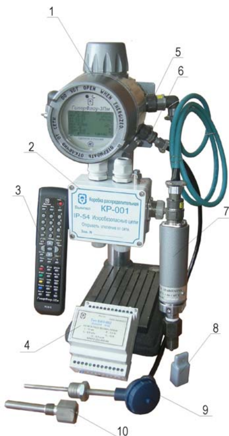
Рисунок 2 – Модели 1003 – 1008, 1102 – 1105 для работы совместно со счетчиками объемного расхода газа (режим корректора)
