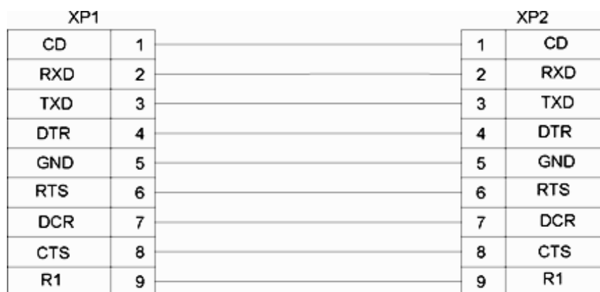
Рисунок И.5 – Схема кабеля ВМПЛ4.842.002 для подключения «ГиперФлоу-МК» к комплексу измерительному ультразвуковому «ГиперФлоу-УС»
