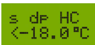
Рисунок 12. Состояние индикатора, когда dpW выше dpHC .
