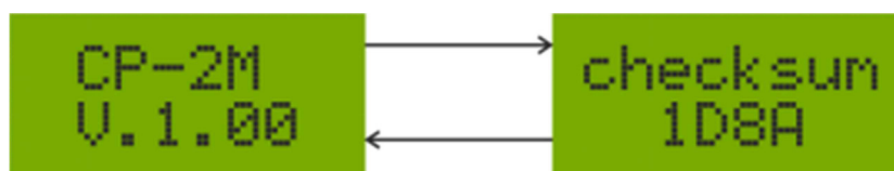
Рисунок 8. Состояние индикатора при выводе версии и контрольной суммы ПО.
